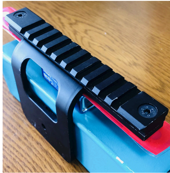
図 4: 照準器の取付に必要なマウントレール
