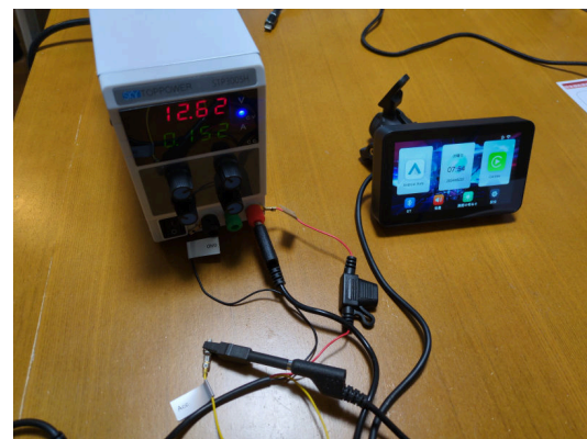
図 3 安定化電源を用いた動作確認の様子
