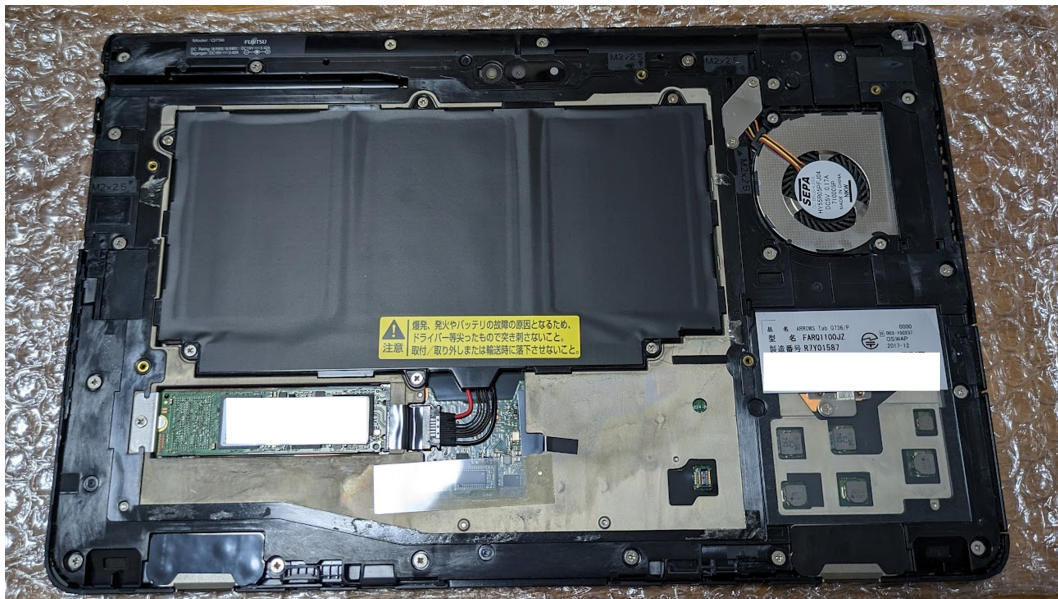
図2 バッテリー交換後の本体
